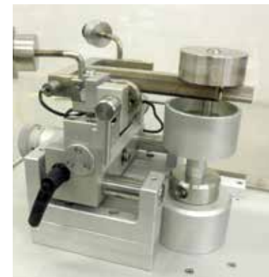
油中回転ボールオンディスク試験
