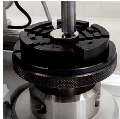
回転スピンドルのディスク試料とボールホルダー
