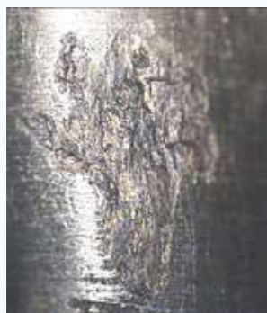
ガス焼けによる金型鋼表面の損傷例
