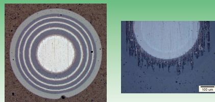
セルテス T 多層 3.7 μm カロテスト研磨痕(高速回転カロテスト) 高速回転カロテストによる繰り返し衝撃による被膜脱落例 (CrN/DLC)
